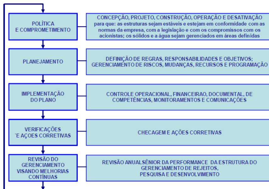
Figura 03: Estrutura canadense de gerenciamento de barragens de rejeitos.
